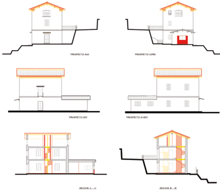
fig.1 - fase 1, appalto edifici A e B - demolizione e ricostruzione, sezioni e prospetti
