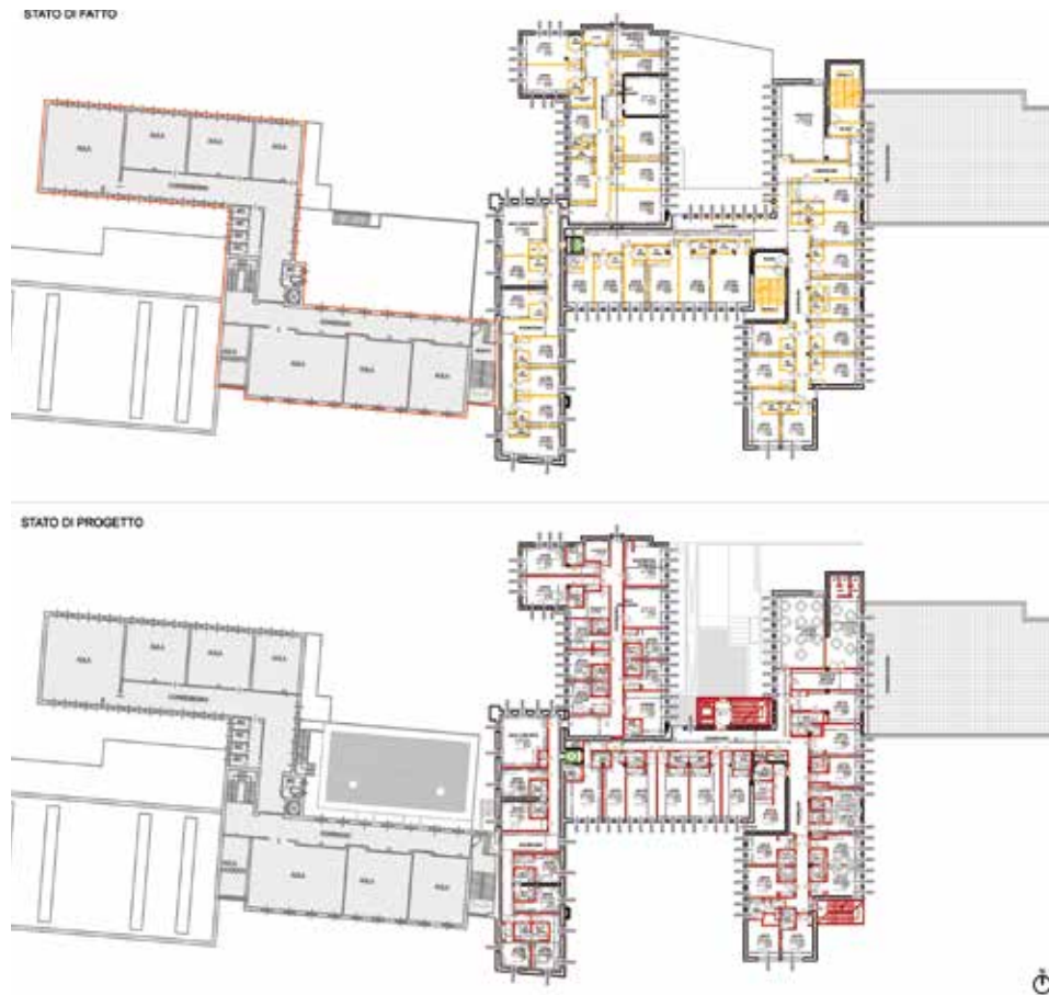
fig.1 - fase di progetto degli interni - demolizione e ricostruzione di un piano dell'edificio
